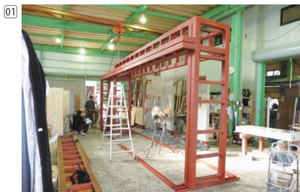
弊社基本の構造計算書に基づき鉄骨下地製造
