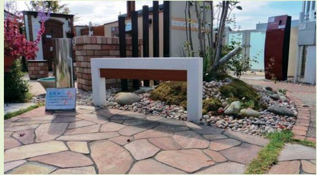
FIT GUARD『フィット・ガード』は低木を生かしベンチにもなるアイテムです。夏の炎天下では鉄骨が熱せられることによる火傷、もしくは熱焼を防ぐことが重要です。そこで防水・遮熱両方を兼ね揃えた塗料を塗布しました。
