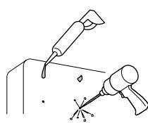
① インパクト及び電気ドライバーで下穴を空ける。
