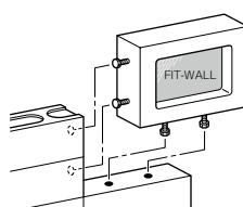
③ コーチボルトの頭が30mm~60mm程度みえるように締めつける。
