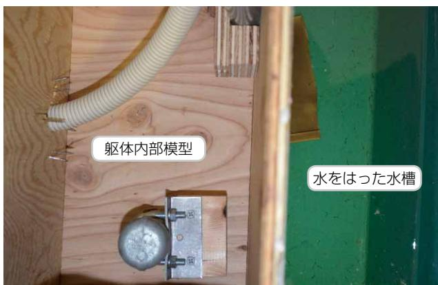
躯体模型を強制水没させるテスト。組込んだ部品の隙間からも水の浸入は見られません。
