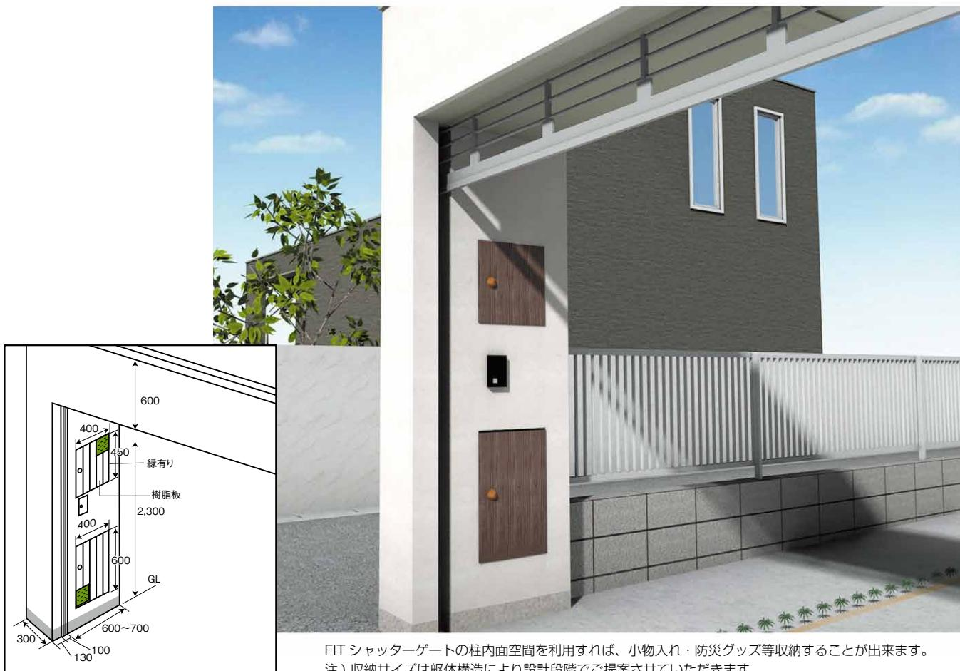
FIT シャッターゲートの柱内面空間を利用すれば、小物入れ・防災グッズ等収納することができます。
