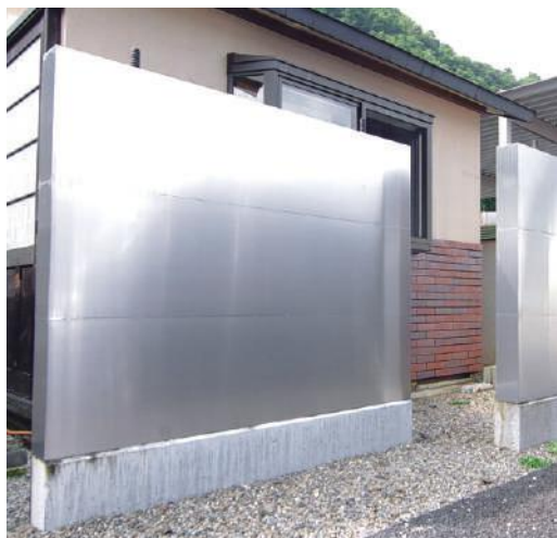
国立岐阜大学工学部の指導のもと実証実験を行いました。最大荷重約3.8kN (風速55m/s以上相当) でも倒壊せず牽引終了後、緩やかに元の位置に戻りました。
