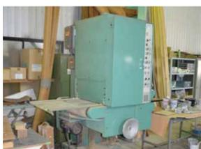
短時間で大きな面にペーパー仕上げ加工
