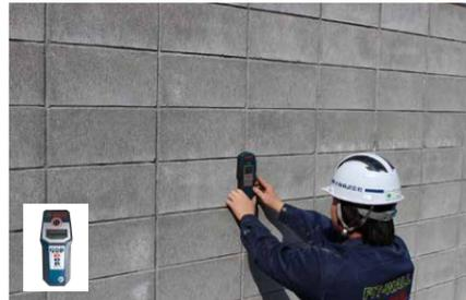
①金属探知機による鉄筋調査
