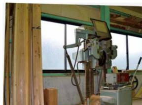
4枚の鋸刃が同時に動きホゾ加工
