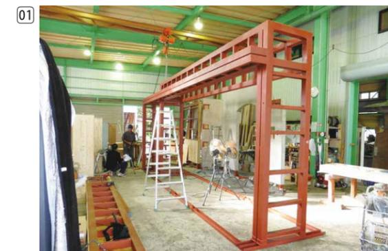
01 弊社基本の構造計算書に基づき鉄骨下地製造
