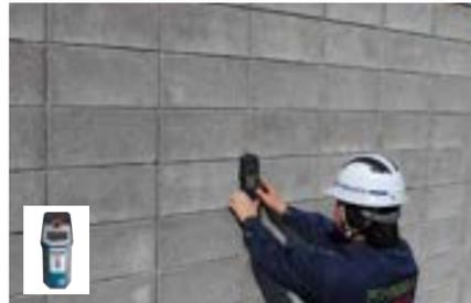
⑪金属探知機による鉄筋調査
