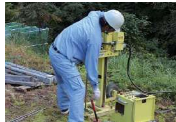
(地盤調査の状況) スウェーデン式サウンディング調査の場合、調査後SWS値をN値に換算
