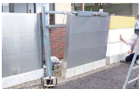
国立岐阜大学工学部の指導のもと実証実験を行いました。最大荷重約3.8kN (風速55m/s以上相当) でも倒壊せず牽引終了後、緩やかに元の位置に戻りました。
