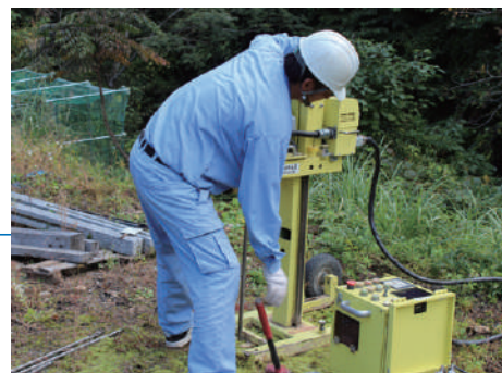
(地盤調査の状況) スウェーデン式サウンディング調査の場合、調査後SWS値をN値に換算
